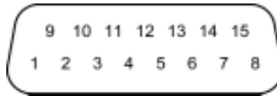
Figura 6: Disposición de las patillas del puerto de datos
